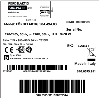
La figure ci-dessus représente la plaque signalétique de l'appareil. Le numéro de série est spécifique pour chaque produit.
