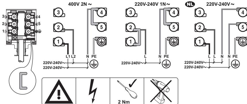
**i** Insira os shunts entre os parafusos conforme exibido.
