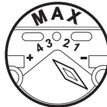
Sie können die Zugabemenge des Klarspülmittels einstellen, indem Sie den entsprechenden Regler zwischen Position 1 (geringste Menge) und Position 4 (größte Menge) einstellen.
