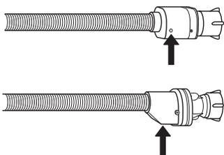
Per i tubi anti-allagamento: controllare la finestrella di ispezione della valvola di sicurezza (vedere la freccia). Se è rossa, significa che la funzione anti-allagamento si è attivata; in questo caso il tubo deve essere sostituito con uno nuovo.
