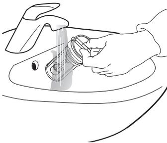
6. Inserire il filtro dell'acqua e reinstallare lo zoccolo:
