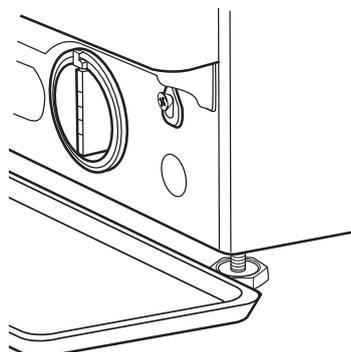
3. Scaricare l'acqua: ruotare lentamente il filtro in senso antiorario fino alla completa fuoriuscita dell'acqua. Lasciar defluire l'acqua senza rimuovere il filtro. Quando il recipiente è pieno, chiudere il filtro dell'acqua ruotandolo in senso orario. Vuotare il recipiente. Ripetere la procedura fino alla completa fuoriuscita dell'acqua.
