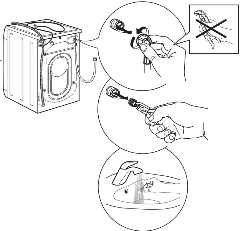
4. Filtersieb wieder einsetzen. Schließen Sie den Zulaufschlauch wieder an den Wasserhahn und die Waschmaschine an. Verwenden Sie kein Werkzeug, um den Zulaufschlauch anzuschließen. Öffnen Sie den Wasserhahn und überprüfen Sie, dass alle Anschlüsse dicht sind.
