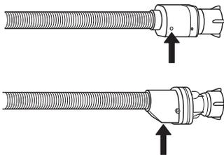
Für Wasserstoppschläuche: Überprüfen Sie das kleine Kontrollfenster des Sicherheitsventils (siehe Pfeil). Wenn es rot ist, wurde die Funktion zum Wasserstopp ausgelöst und der Schlauch muss durch einen neuen ersetzt werden.
