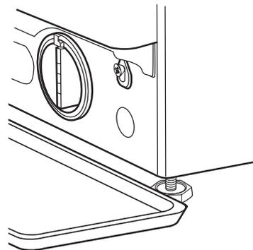
3. Vidanger l'eau : tournez lentement le filtre dans le sens inverse des aiguilles d'une montre jusqu'à ce que de l'eau ressorte. Laissez l'eau se vidanger sans enlever le filtre. Lorsque le récipient est plein, fermez le filtre à eau en le tournant dans le sens horaire. Videz le récipient. Répétez cette procédure jusqu'à ce que toute l'eau soit vidangée.
