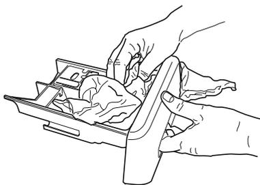
5. Remplacez le distributeur de détergent et poussez-le en place dans le compartiment de détergent.
