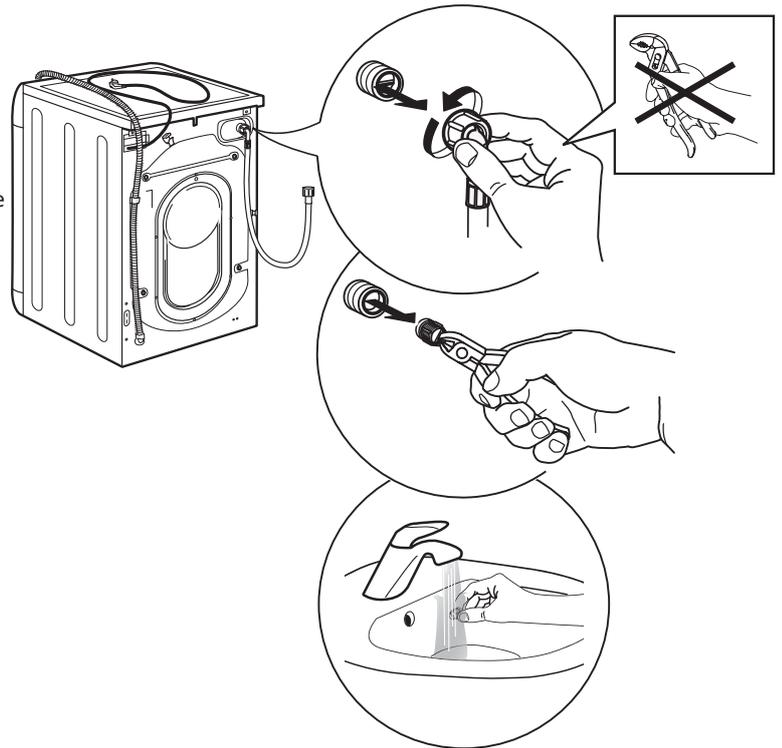
4. Remplacez le filtre à tamis. Rebranchez le tuyau d'alimentation au robinet d'eau et au lave-linge. N'utilisez pas d'outils pour brancher le tuyau d'alimentation. Ouvrez le robinet d'eau et assurez-vous que tous les raccords sont bien serrés.
