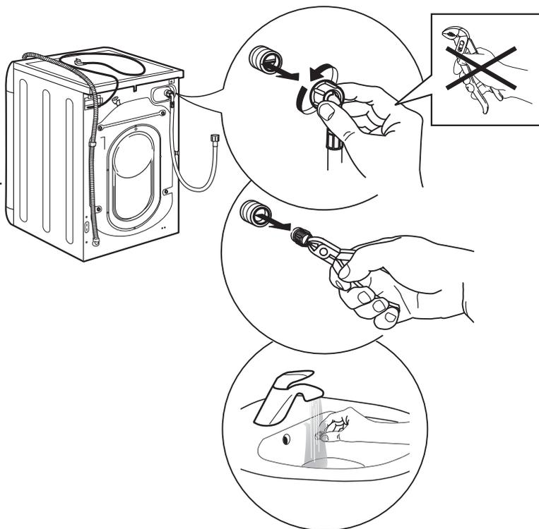
4. Reinserire il filtro a rete. Ricollegare il tubo di carico al rubinetto dell'acqua e alla lavatrice. Non usare utensili per collegare il tubo di carico. Aprire il rubinetto dell'acqua e controllare che tutti i collegamenti siano ben stretti.
