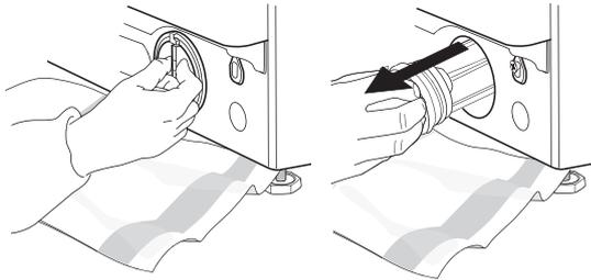
5. Reinigen Sie den Wasserfilter:
