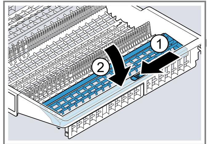
2. Um die vorderen Stachelreihen umzuklappen, den Hebel nach vorne drücken und die Klapstacheln umklappen ①.
