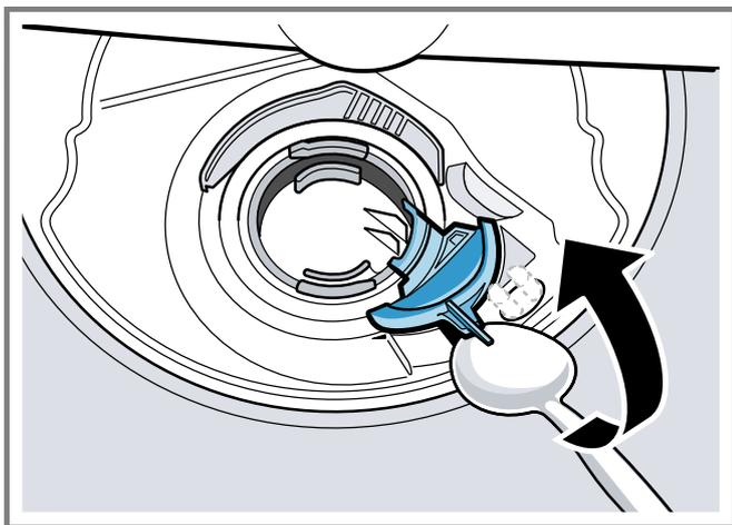
6. Die Pumpenabdeckung schräg nach innen anheben und entnehmen.
